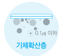
전극막에 수소/공기 공급 미세기공층에서 초미세먼지 제거 (미세기공층 크기 : 0.1 \mu g 이하)
